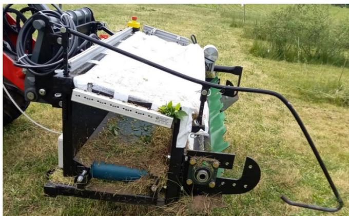
Abb. 2: Prototyp des fertigen Mähwerks (ATB)
