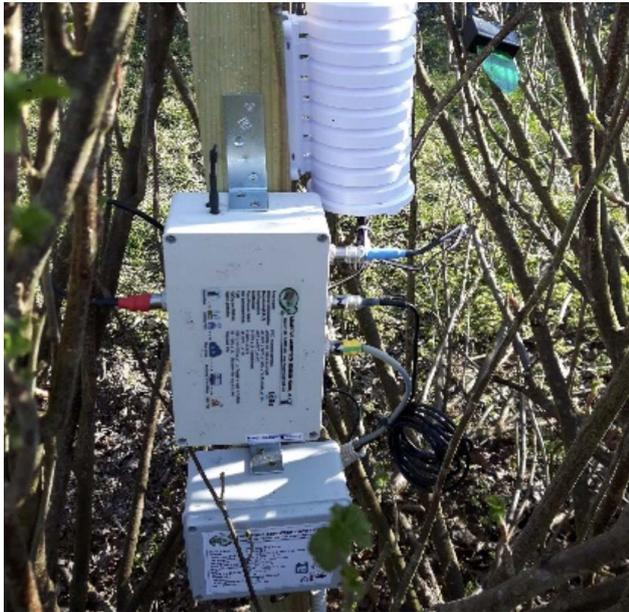
Foto: LoRaWAN-System mit Backup Logger-System am Standort Schöneiche
