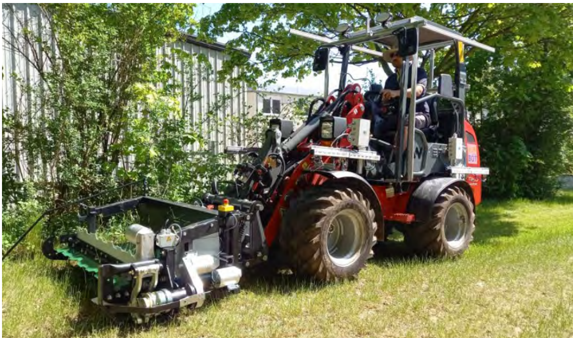
Abb. 1: Fertig umgebaute SunBot-Maschine mit dem für das Projekt gefertigten Mähwerk (© Shamshiri)
