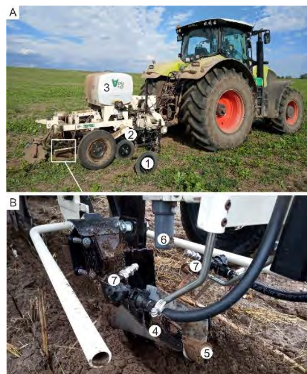
Abbildung 1: Mobile Sensorplattform (MSP 3) von Veris technologies (Salina, USA) mit Geoelektrik (1), optischem Sensor (3) und pH-Messsystem (Wassertank (3), pH-Probennehmer (4), Bodenprobe (5), pH-Elektroden (6) und Sprühdüsen (7) zur Reinigung.
