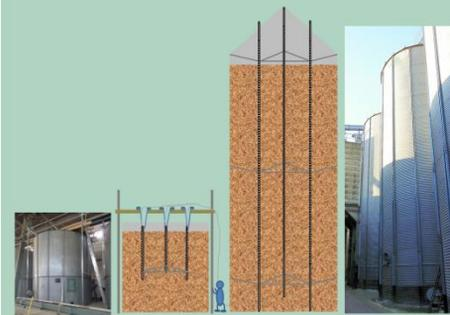
Bild 1: „Beetle Sound Tube“ System in zwei Silos.
