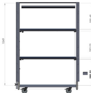
Abbildung 4: Schema finale Konstruktion vertikales Anbausystem
