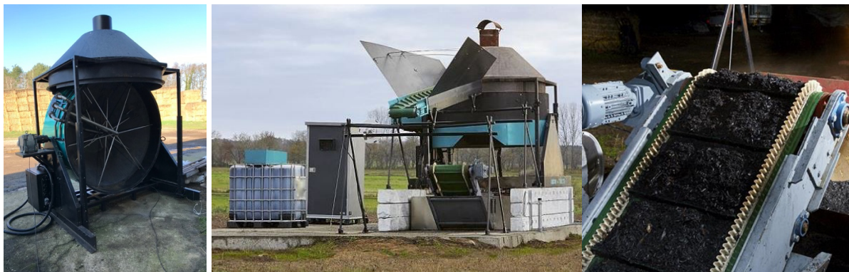
Abbildung 3: Carbon Twister® mit verbesserter Zündung und Brennraumabdeckung, sowie Zuführung und Entnahme, das fertige Produkt
